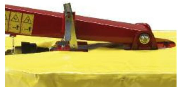
La sostituzione delle lame è un'operazione semplice ed immediata: basta svitare la vite di tre giri e far leva con la chiave per inserire il coltello nel perno e infine fissare la vite.
